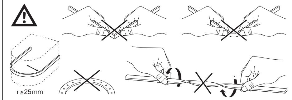
**HR:** Montaža modula se vrši pomoću dvostrane ljepljive trake smještene na poledini. Pazite na čiste površine, koje moraju biti bez masti, ulja, silikona i čestica prljavštine. Pazite na potpuno odstranjenje zaštitne trake.
